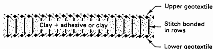
図-4 GCL断面図(クレイマックス SP500)
